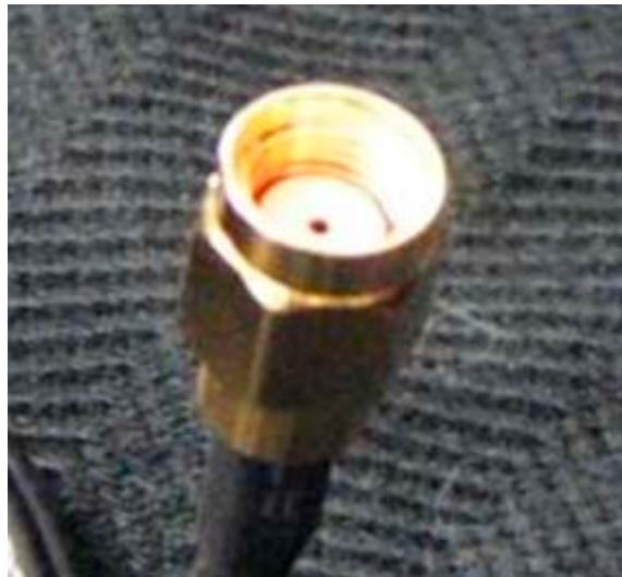
**Figure 1.4 RP-SMA-M**
