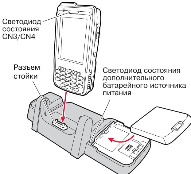
Светодиод состояния CN3/CN4 – красный, когда идет зарядка CN3/CN4, и зеленый, когда CN3/CN4 полностью заряжен.
