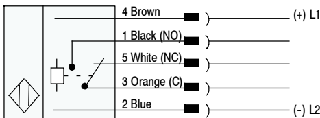
5-Pin AC/DC Mini QD Models
